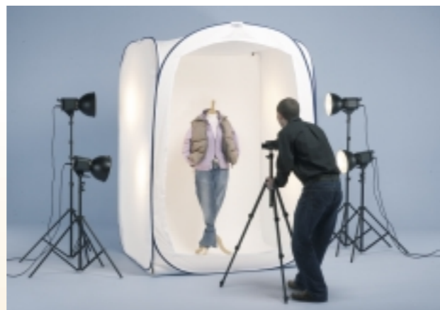
Składane komory bezcieniowe produkowane przez angielską firmę Lastolite. Ich rozmiary sięgają od 48 do 200 cm. Przy ich użyciu można fotografować zarówno biżuterię, średniej wielkości obiekty jak i niewielkie meble.
